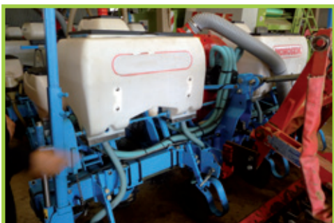
Semoir avec distributeur de microgranulés phyto.
